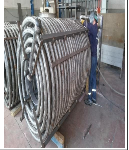
ÜRDÜN FOSFAT GÜBRE FABRİKASI ENDÜSTRİYEL KURUTUCU EŞANJÖR İMALATI
